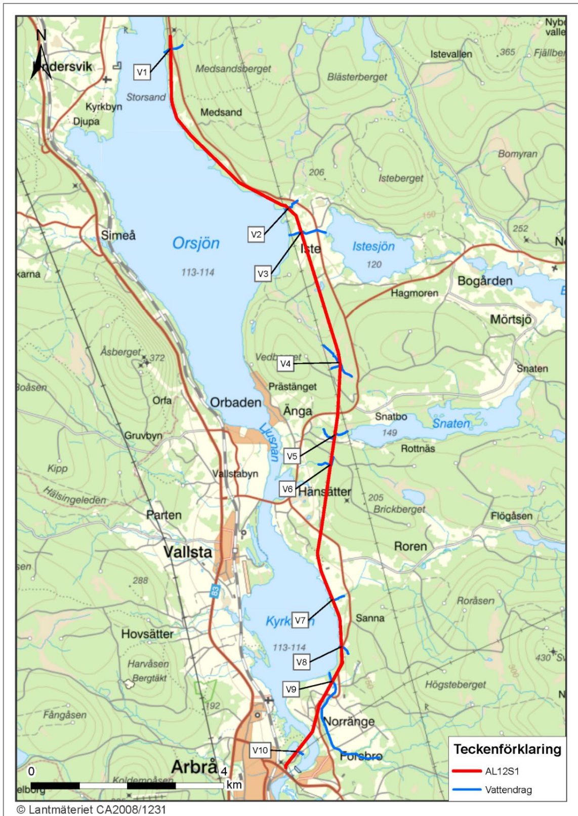
Figur 11. Vattendrag som korsas i luft av befintlig luftledning.
